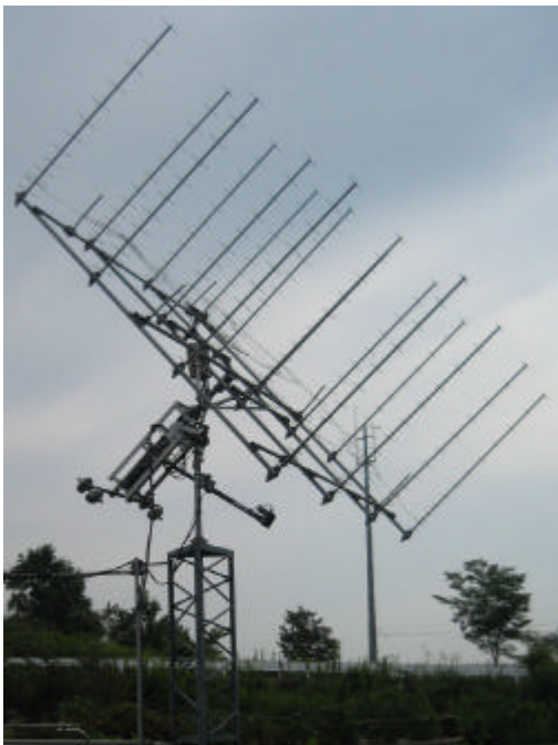
JJ1NNJ 16 x 13 el yagis rotatable pol array
