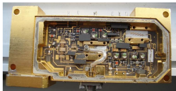
9A5AA's modified 24 GHz ARCOM TX Module
