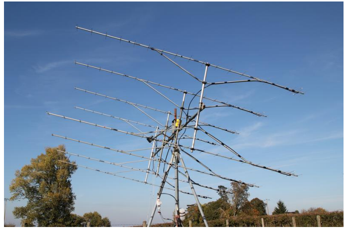
F6HLC's 8x21 el F9FT yagi array for 70 cm EME
