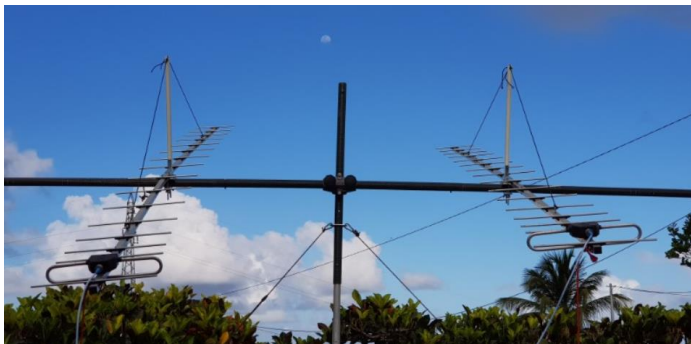
TO2MB's 432 2 x 17 el yagi array (source DL1RPL.de)
