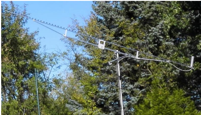
DL1DWI 70 el yagi used on 1296 EME
